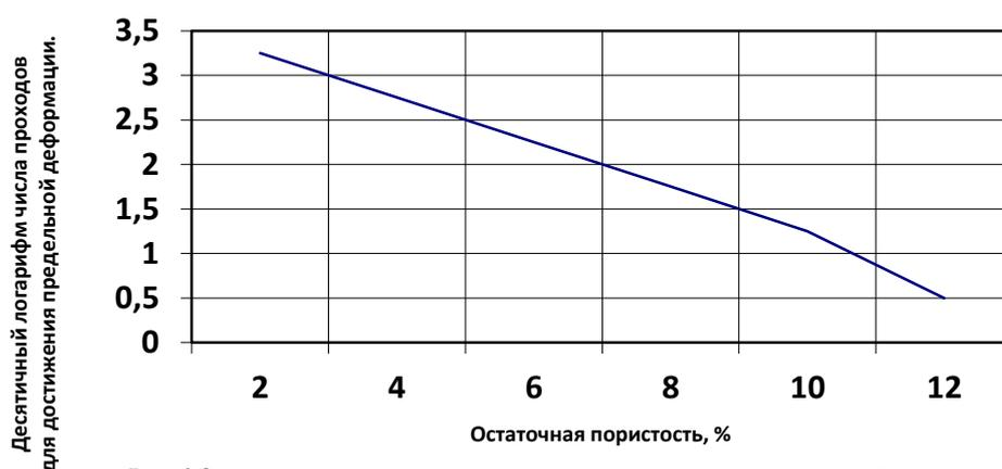
Рис. 3 Зависимость количества циклов для достижения предельной деформации от остаточной пористости.
