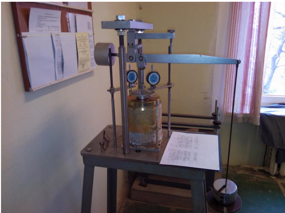
Рисунок 2 – Штампові випробування зразків на важільному пресі
