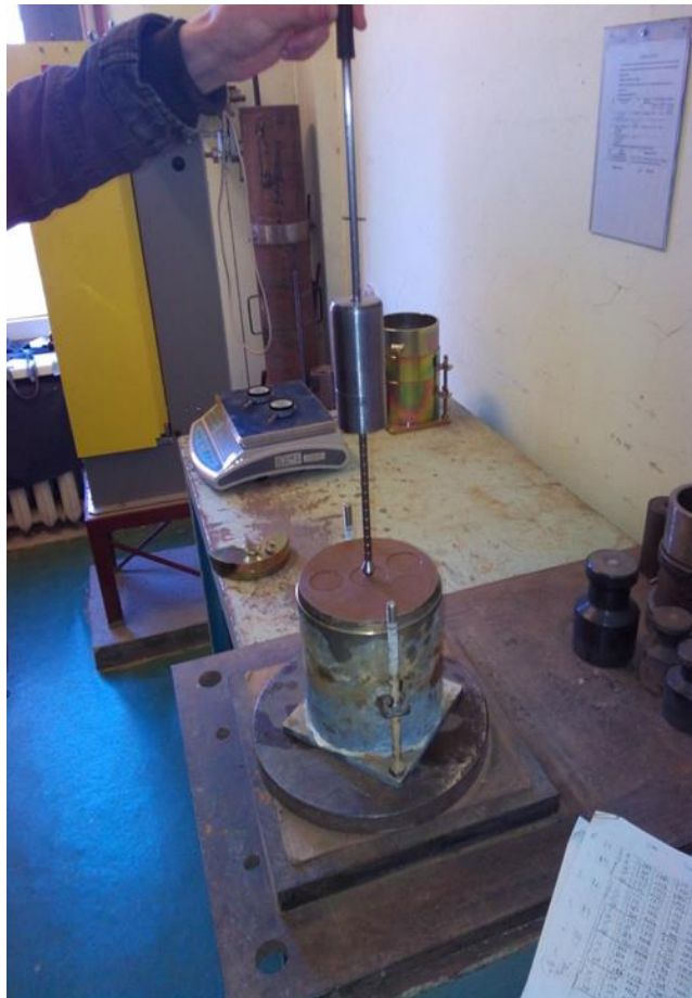
Рисунок 1 – Пристрій для динамічного зондування зразків в лабораторії
