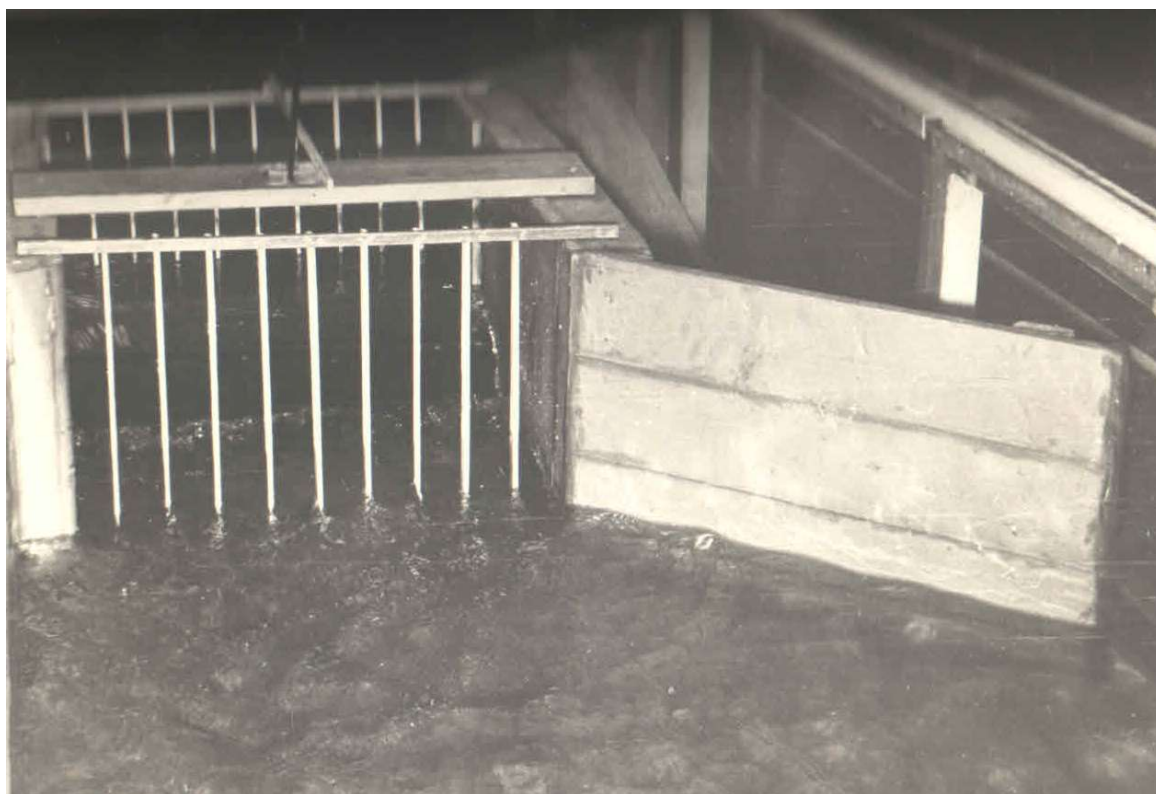
Рис. 3 – Модель споруди у гідравлічному лотку лабораторії кафедри в масштабі 1:40.
