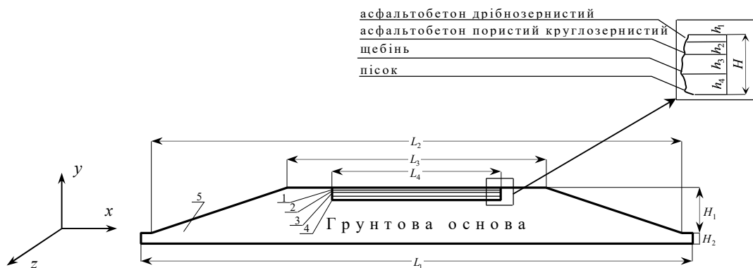
Рисунок 3 – Схема поперечного перерізу конструкції дорожнього покриття
