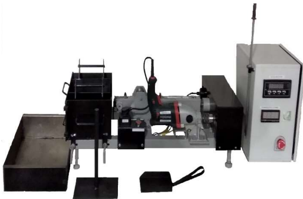
Рисунок 6 – Прилад для визначення легкоукладальності асфальтобетонної суміші
