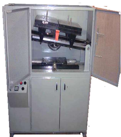
Рисунок 1 – Обладнання для виготовлення зразків асфальтобетону з пристосуванням для випробування зразків на колієутворення
