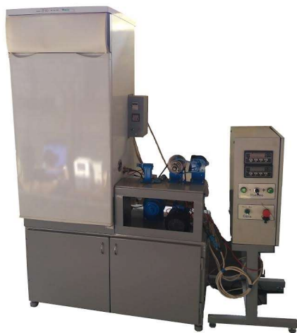
Рисунок 7 – Прилад для визначення динамічних модулів пружності зразків з асфальтобетонних матеріалів (вібростенд)
