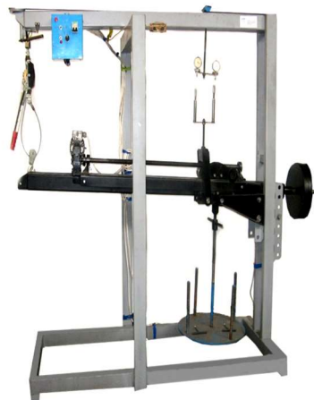
Рисунок 3 – Прилад для визначення розрахункових характеристик армованого асфальтобетону
