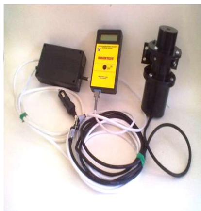
Рисунок 10 – Прилад для визначення рівності покриття автомобільної дороги
