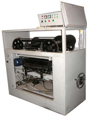
Рисунок 2 – Обладнання для виготовлення зразків з армованого асфальтобетону
