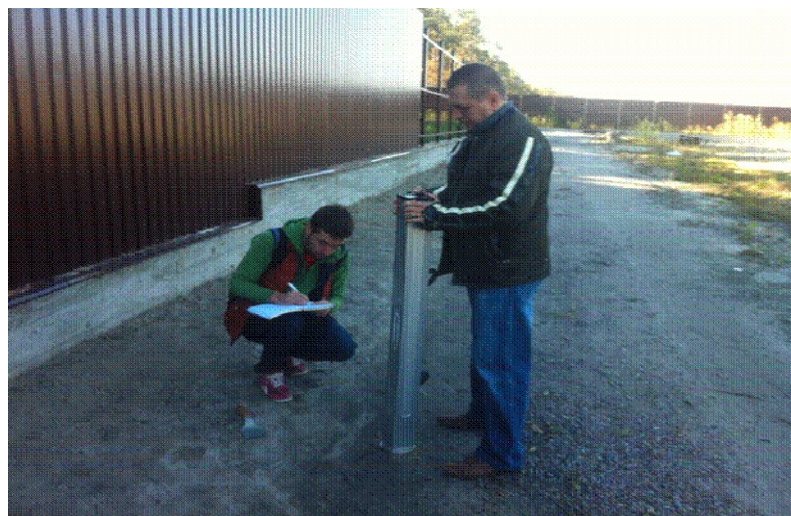
Рисунок 3 – Проведення випробувань по вимірюванню динамічного модуля пружності (ділянка 1, INSPECTOR 3)
