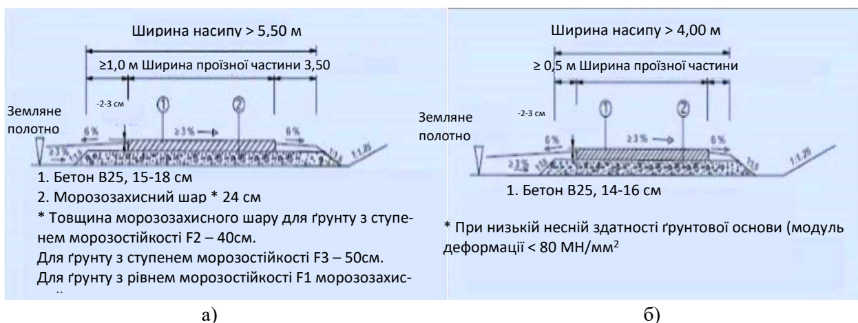
Рисунок 2 – Влаштування шару із укоченого бетону: а) односмугової з'єднувальної (з високою інтенсивністю руху); б) сільськогосподарської дороги
