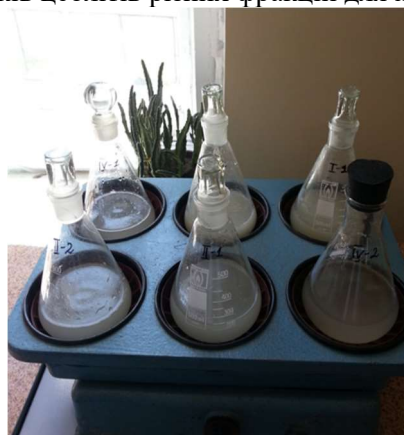
Figure 3 – Use of zeolite samples of different fractions for simulation of surface runoff Рисунок 3 – Використання зразків цеолітів різних фракцій для моделювання поверхневих стоків
