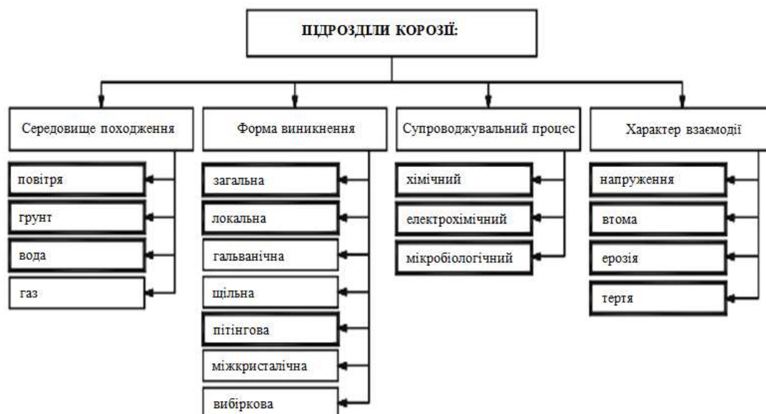
Рисуюнок 2 – Класифікація найбільш часто поширених видів корозії. Figure 2 – Classification of the most common types of corrosion.
