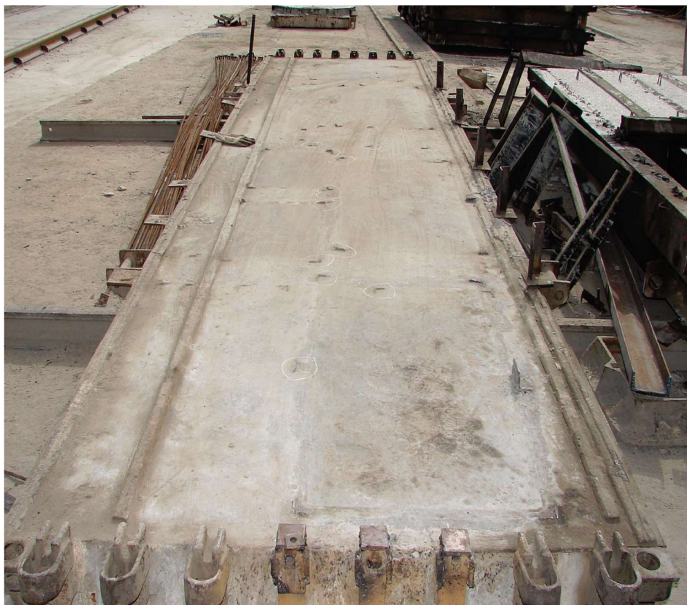
Рисунок 2 – Опалубочна форма для пустотних залізобетонних панелей Figure 2 – Formwork for hollow reinforced concrete panels
