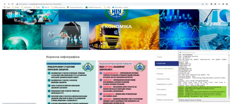
Рисунок 12 – Результат зчитування елемента <img> за допомогою NVDA після додавання тексту до атрибуту «alt».
