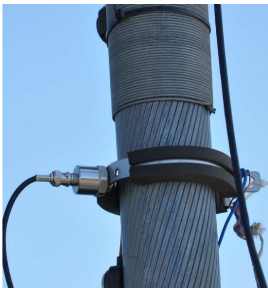
Рисунок 4 – Кріплення п'єзоелектричного перетворювача прискорення Sensing Tech CT11000L на канаті за допомогою клемового затискача
