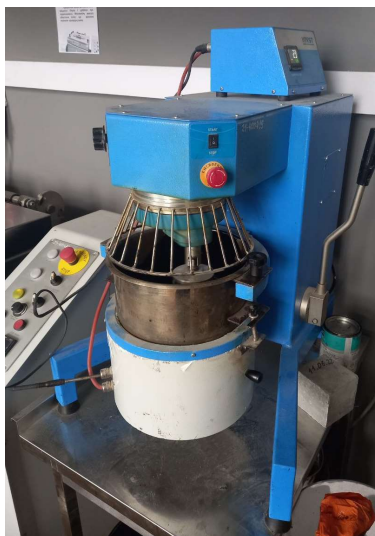
Рисунок 1 – Лабораторний перемішувач для сумішей і в'язучих матеріалів Figure 1 – Laboratory mixer for mixtures and binder materials
