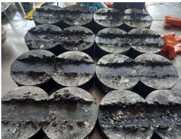
Рисунок 8 – Візуальне порівняння зразків після випробування на колієвимірвальній машині Figure 8 – Visual comparison of samples after tests on a track-measuring machine
