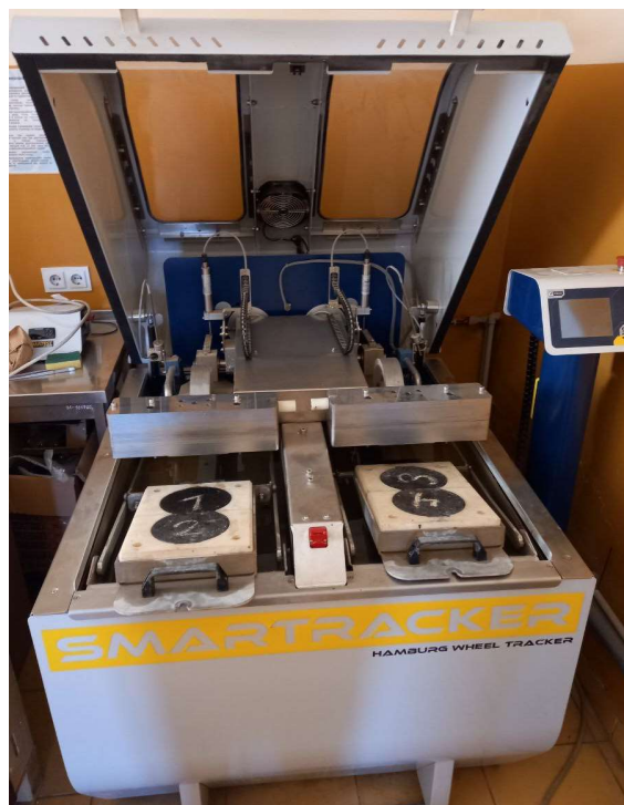
Рисунок 5 – Випробування зразків асфальтобетону на утворення колії Figure 5 – Testing asphalt concrete samples for rutting
