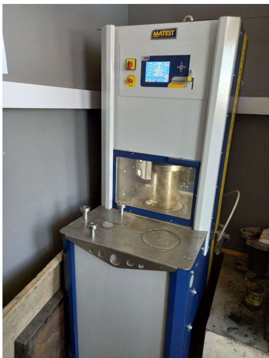
Рисунок 4 – Формування зразків для визначення колійності у гіраторному компактаторі Figure 4 – Formation of samples for determining rutting in a gyratory compactor
