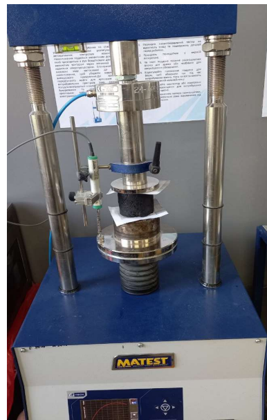
Рисунок 3 – Випробування стандартних зразків при одноосьовому стиску для визначення границі міцності при стиску Figure 3 – Testing of standard samples at a single sided compressed to determine the strength boundary at a compressed
