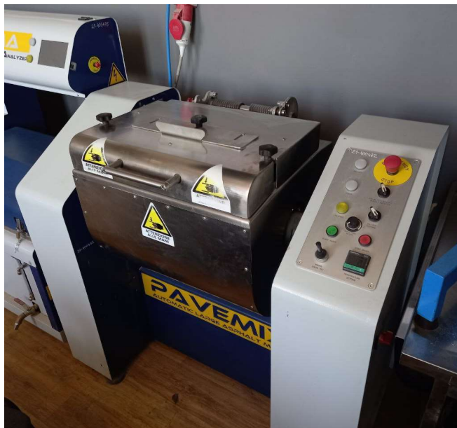
Рисунок 2 – Асфальтний лабораторний змішувач Figure 2 – Asphalt laboratory mixer
