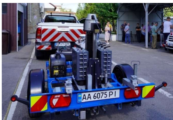
Рисунок 8 – Установка динамічного навантаження Dynatest Falling Weight Deflectometer та виміряно чаша прогину Figure 8 – Dynatest Falling Weight Deflectometer & deflection bowl. ([2])
