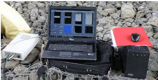
Рисунок 1 – Обладнання на базі АЦП ADA-1406
