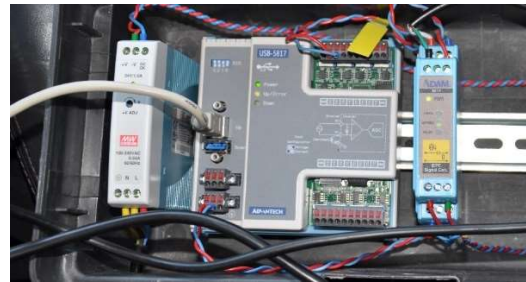
Рисунок 2 – Обладнання на базі АЦП USB-5817
