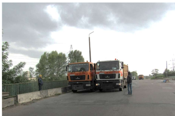
Рисунок 7 – Розташування випробувального навантаження (три автомобілі МАЗ 5516)
