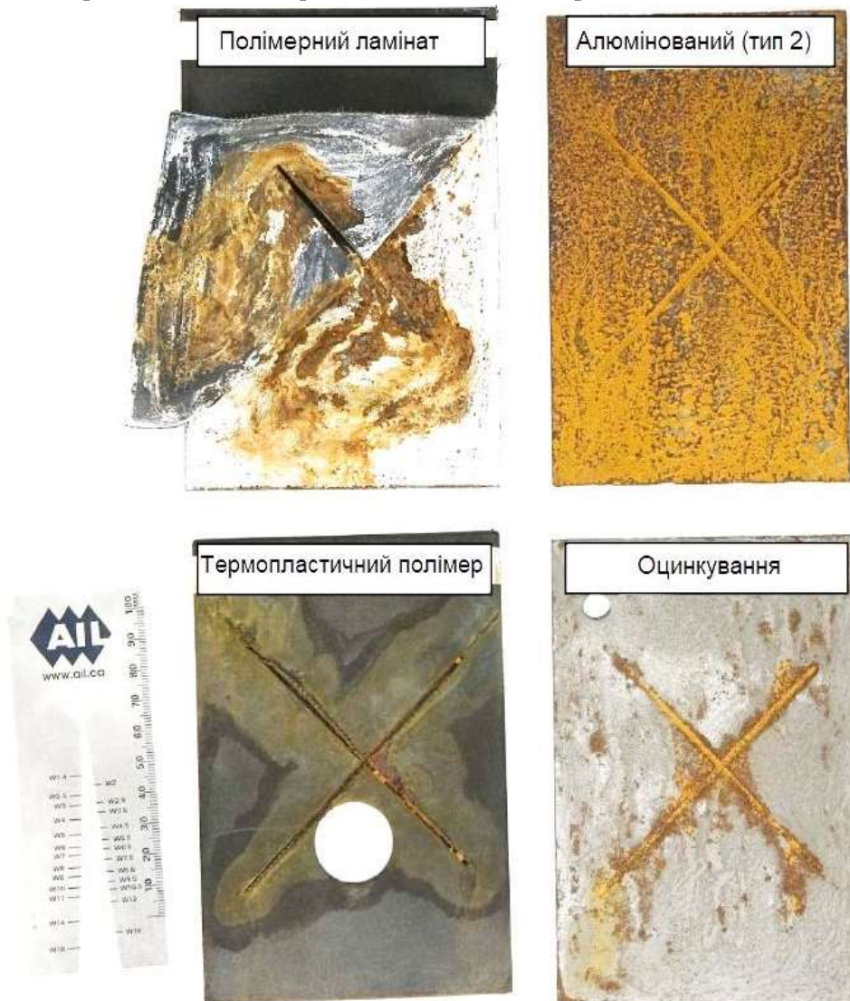
Рисунок 5 – Оцінювання впливу корозії на захисне покриття
