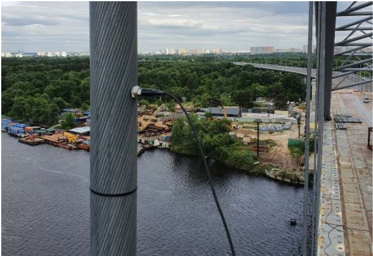
Рисунок 2 – Давач динамічних коливань встановлений на канаті
