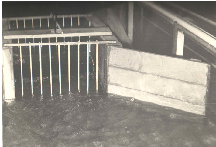
Рисунок 2 – Модель споруди у гідравлічному лотку лабораторії кафедри в масштабі 1:40 Figure 2 – Model of the structure in the hydraulic tray of the department's laboratory at a scale of 1:40
