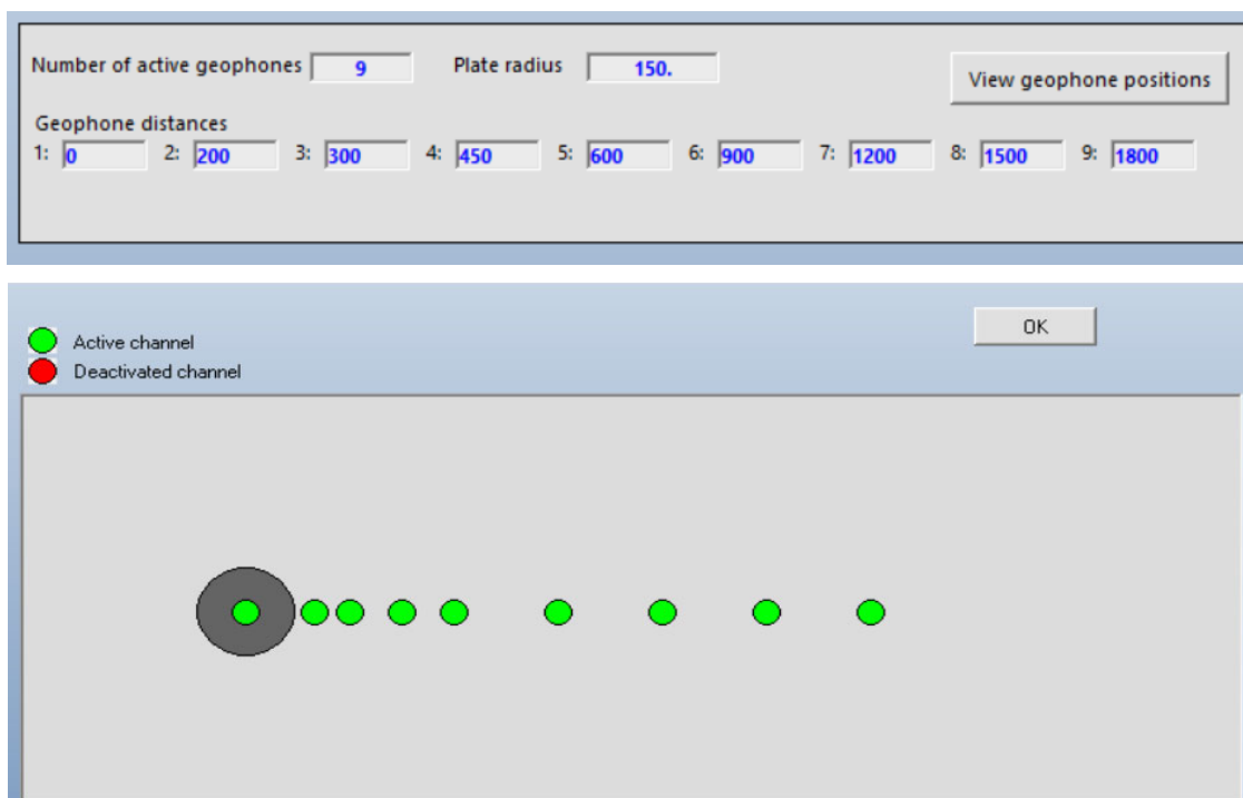
Рисунок 4 – Схема встановлення датчиків за методом FFWD [8] Figure 4 – Sensor installation diagram using the FFWD method [8]
