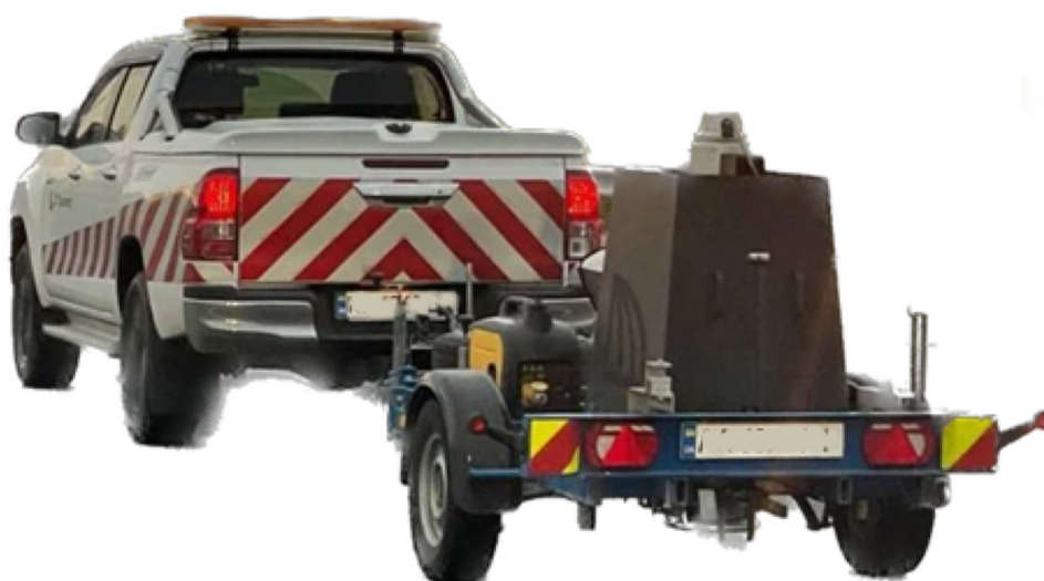
Рисунок 1 – Загальний вигляд пересувної дорожньої лабораторії з устаткуванням FFWD Figure 1 - General view of the mobile road laboratory with FFWD equipment
