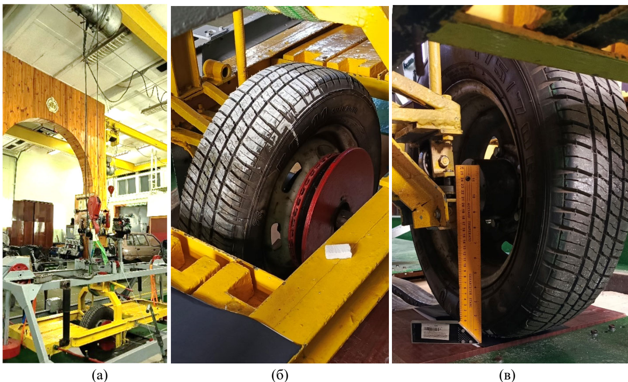
Рисунок 6 – До забезпечення відриву колеса від опорної поверхні (а), визначення розмірів плями контакту (б) та вертикальної деформації шини (в)
