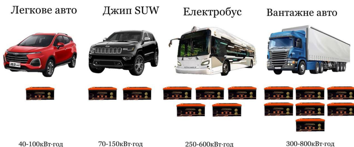
Рисунок 4 – Кількість літій-іонних модульних секційних АКБ, необхідних для транспортних засобів різного типу.
