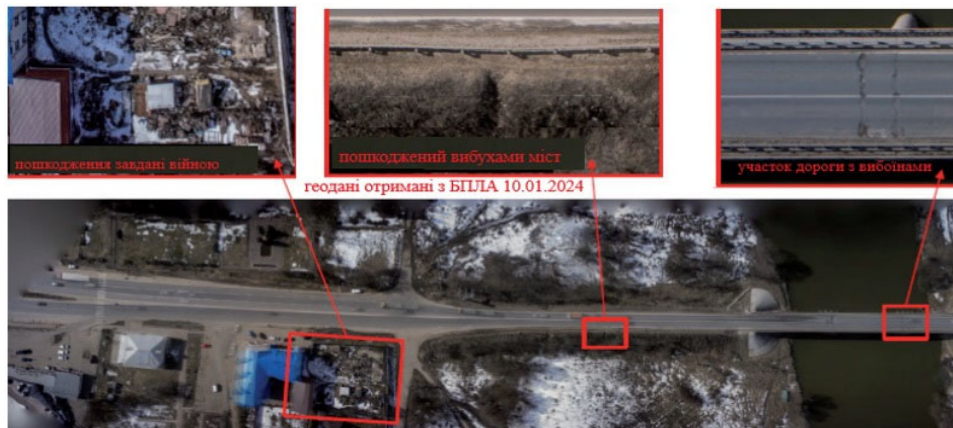
Рисунок 2 – Ортофотоплан досліджуваної дороги (Е 97) та виявлені пошкодження дорожнього полотна
