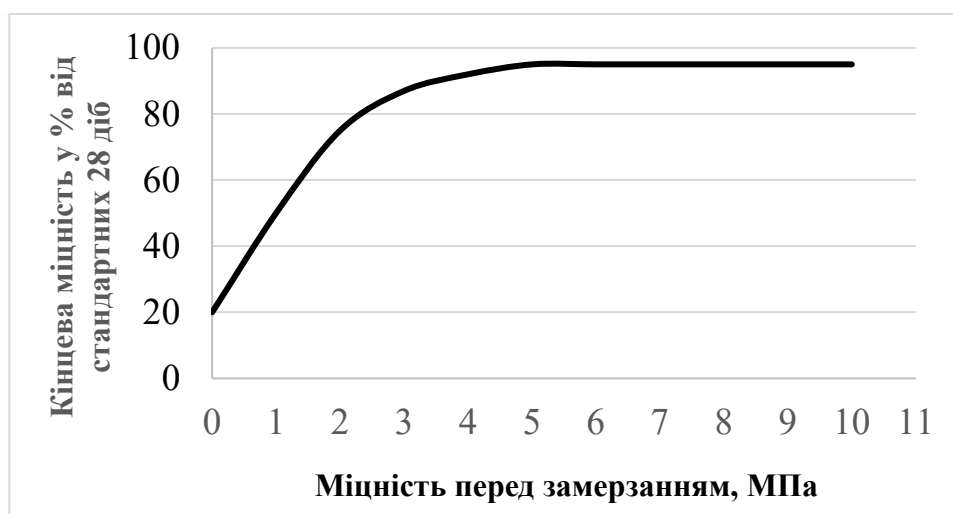
Рисунок 4 – Залежність кінцевої міцності у % від міцності цементобетону перед замерзанням Figure 4 – Dependence of compressive 28 days strength in % on concrete compressive strength before freezing
