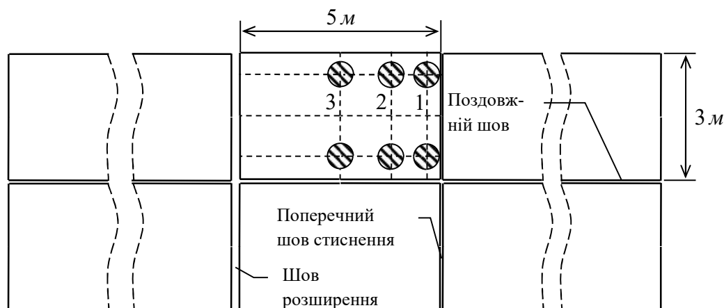
Рисунок 1 – Схема цементобетонного покриття
