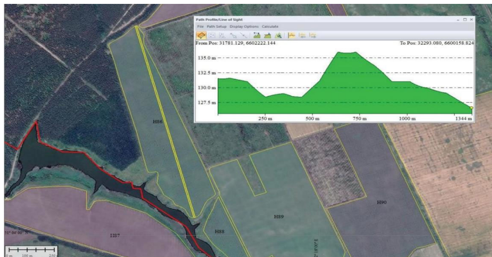
Рисунок 6 – Побудова профілю рельєфу місцевості на основі геодезичних координат з використанням супутникового знімка та цифрової моделі висот [14]
