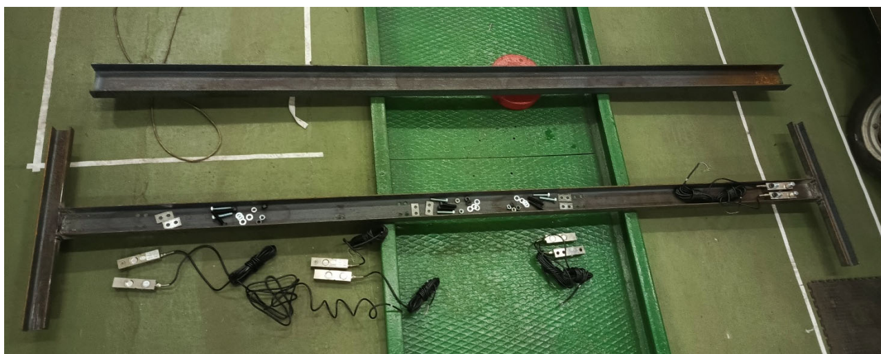
Рисунок 4 – Кришка та основа вимірювальної вантажної платформи
