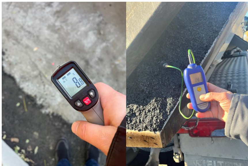
Рисунок 2 – Контроль температури навколишнього середовища і асфальтобетонної суміші Figure 2 – Monitoring of the ambient temperature and the asphalt concrete mixture
