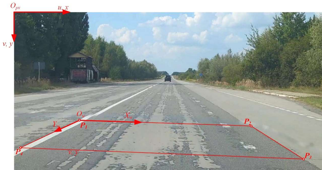
Рисунок 3 – Розташування еталонного квадрата на кадрі ділянки дороги Figure 3 – Location of the reference square on the road section frame
