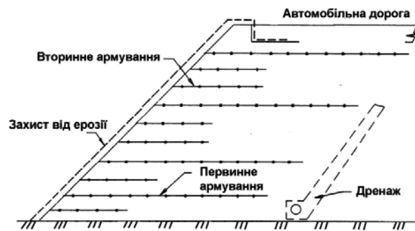
Рисунок 1 – Принцип армування і стабілізації укосу насипу (відповідно до [5])
