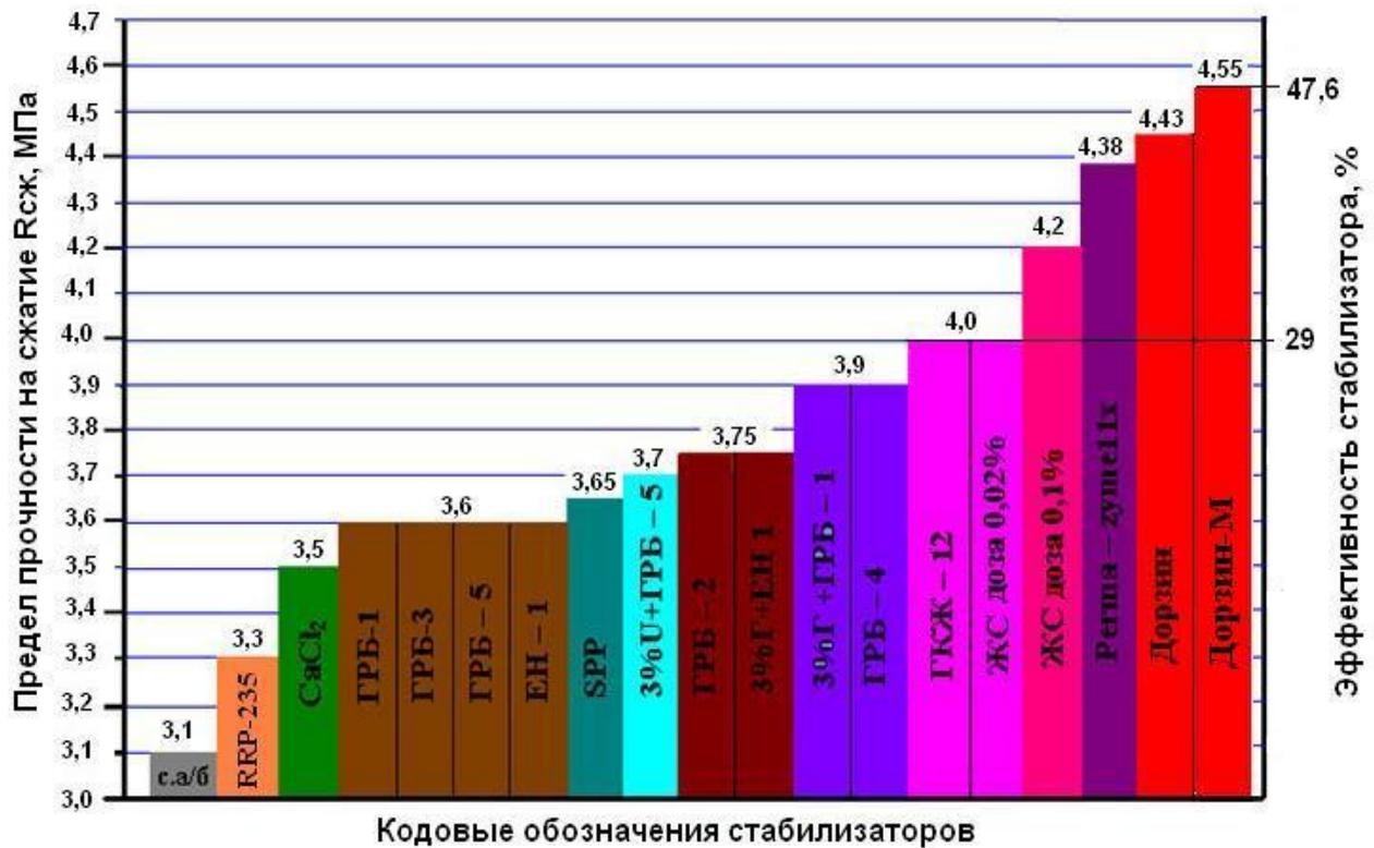
Прочность водонасыщенных образцов смеси 50% фрезерата старого асфальтобетона и 50% суглинка с 4% цемента, заформованных нагрузкой 30МПа в 7 суточном возрасте.
