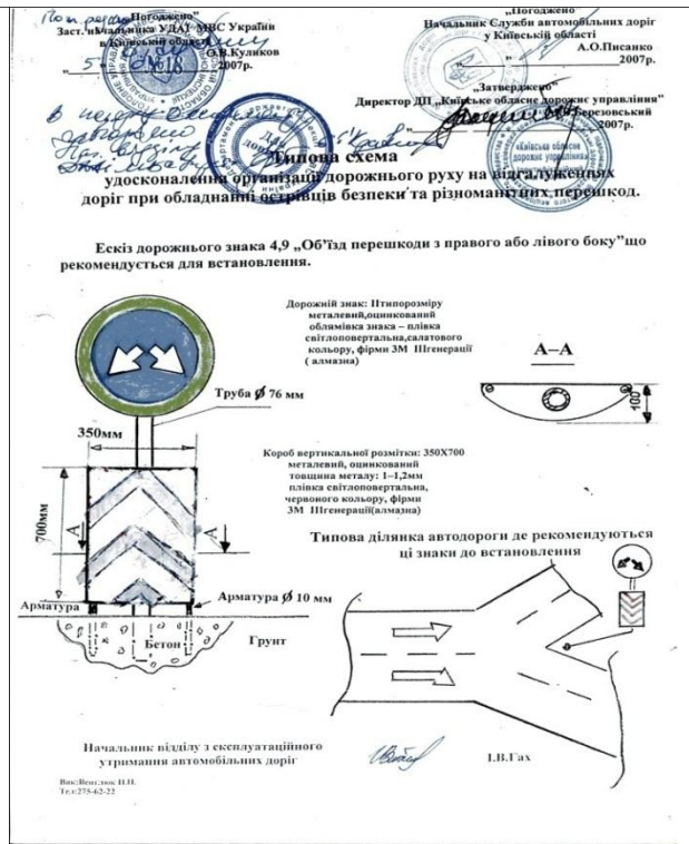
Рисунок 4 – Типова схема удосконалення організації дорожнього руху на відгалудженнях доріг при обладнанні острівців безпеки та різноманітних перешкод
