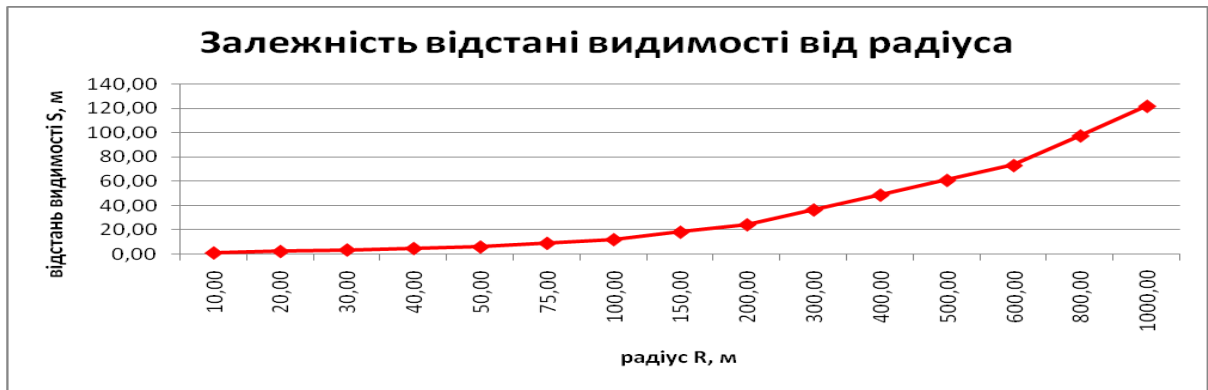
Рисунок 2 – Відстань видимості поверхні дороги на горизонтальних кривих
