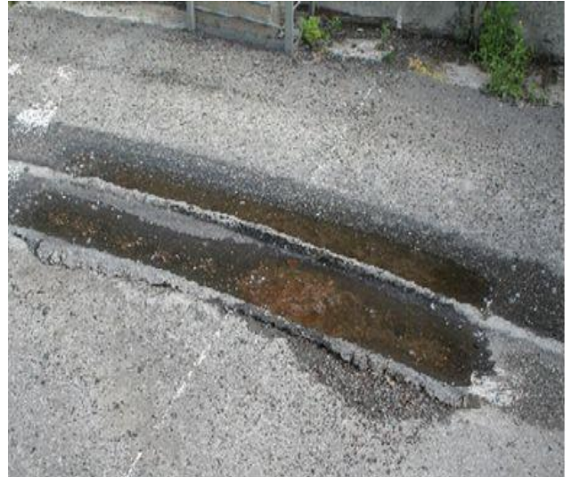
Рисунок 11 - Вигляд карти з холодного асфальтобетону типу Vx після 3000 обертів ственду
