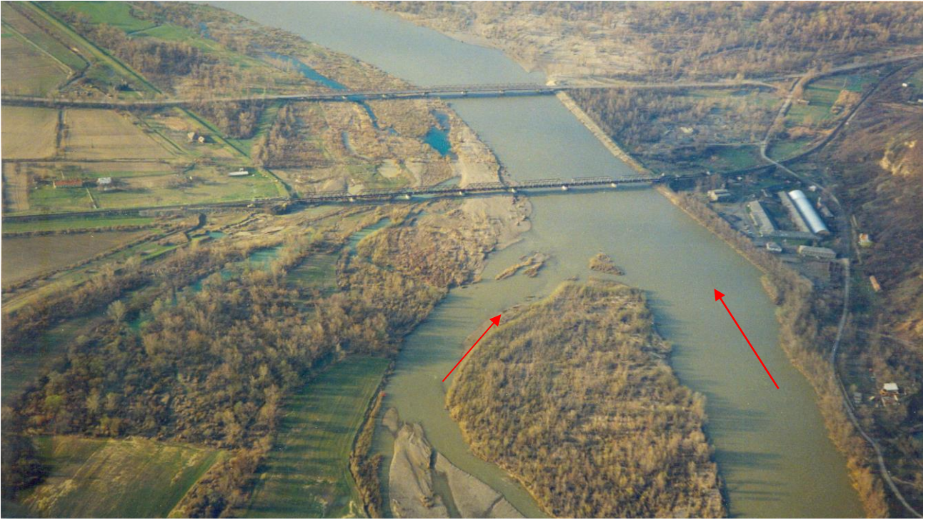
Рисунок 2 – Загальна картина протікання води та розташування акумулятивних форм на р.Тиса біля м. Виноградів на ділянці з існуючими залізнодорожним і автодорожним мостами (залізнодорожний міст розташовано вище за течією)
