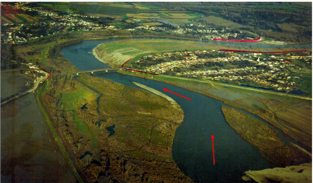
Рисунок 1 – Загальна картина протікання води та розташування акумулятивних форм на р. Тиса на ділянці з існуючим автодорожним мостом біля смт Вилок, розташованим на правому березі річки (фотографії, які наведено на рисунках 1-4, виконано з літального апарата інженером – гідротехніком Барченко В.В. у 2001р.)
