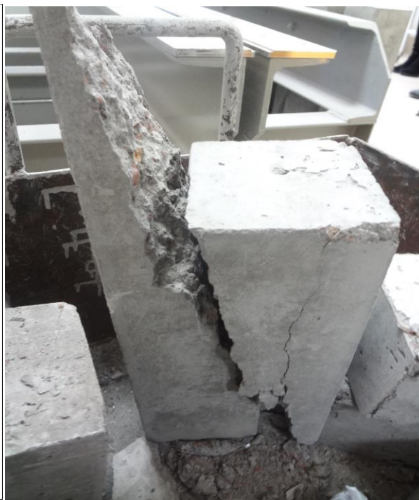
Рисунок 6 – Характерне руйнування зразка – призми
