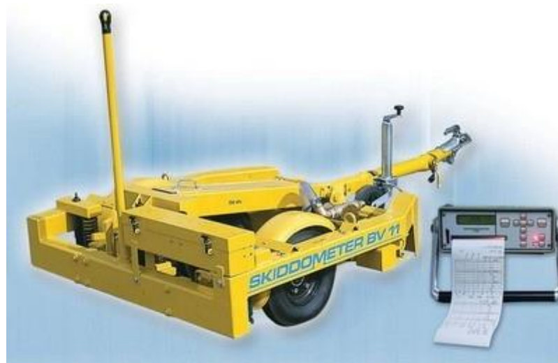
Рисунок 1 - Засоби вимірювання коефіцієнта зчеплення на аеродромах України
