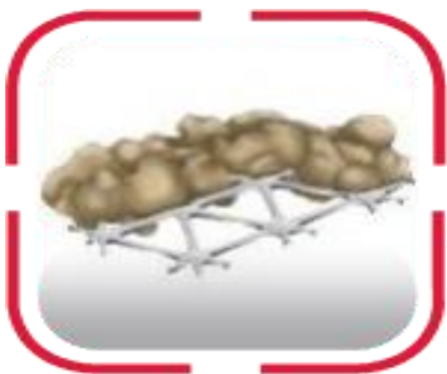
Рисунок 5 – Принцип розподілу навантажень тривісною георешіткою
