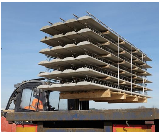
Рисунок 4 – Обладнання для монтажу опалубки: а) транспортні засоби; б) спеціальна траверса для швидкого монтажу
