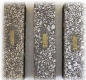
Рисунок 4 – Асфальтобетонні зразки з тензодатчиками
