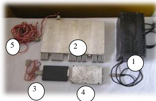
1 – блок живлення; 2 – концентратор-мультиплексор; 3 – адаптер; 4 – модулі аналогово-цифрових перетворювачів (АЦП); 5 – з'єднувальні кабелі
