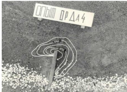
Рисунок 1 – Розмив біля берега річки з напівзагатою ( \alpha = 90^\circ )
