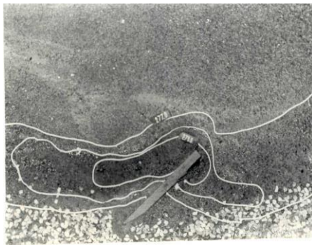
Рисунок 3 – Розмив дна біля одиночної напівзагати без вирізу біля голови і з вирізом при \alpha=45^\circ
