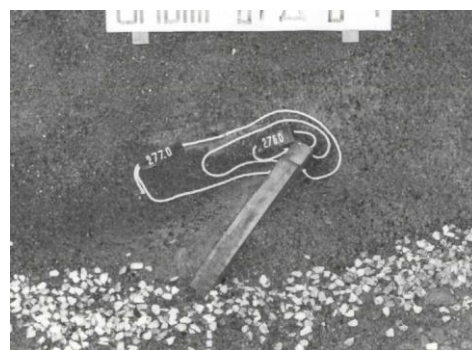
Рисунок 3 – Розмив дна біля одиночної напівзагати без вирізу біля голови і з вирізом при \alpha=45^\circ
