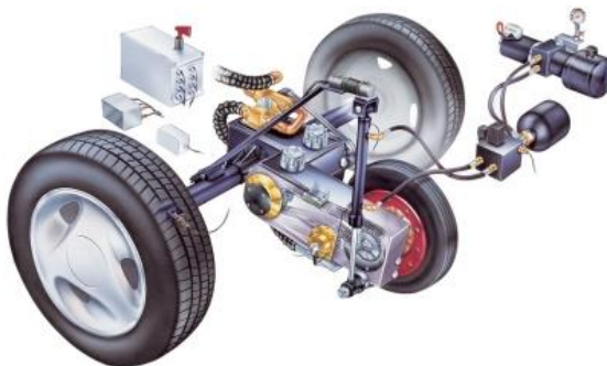
Рисунок 2 – Будова залежної підвіски вимірювача
