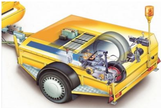
Рисунок 1 – Буксирований вимірювач коефіцієнта зчеплення
