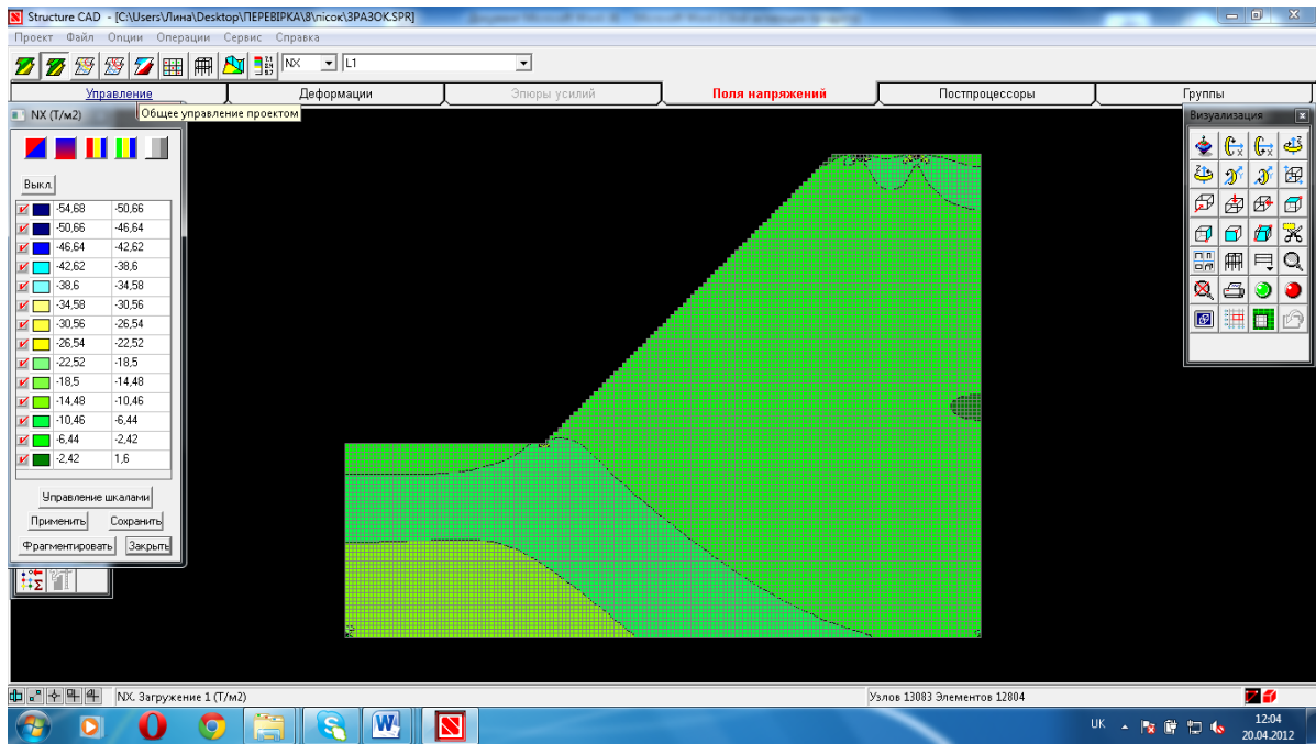
Рисунок 9 – Розподіл нормальних напружень по осі x (навантаження НК-100 у формі зосереджених сил, відстань від брівки земляного полотна 1,0 м)
