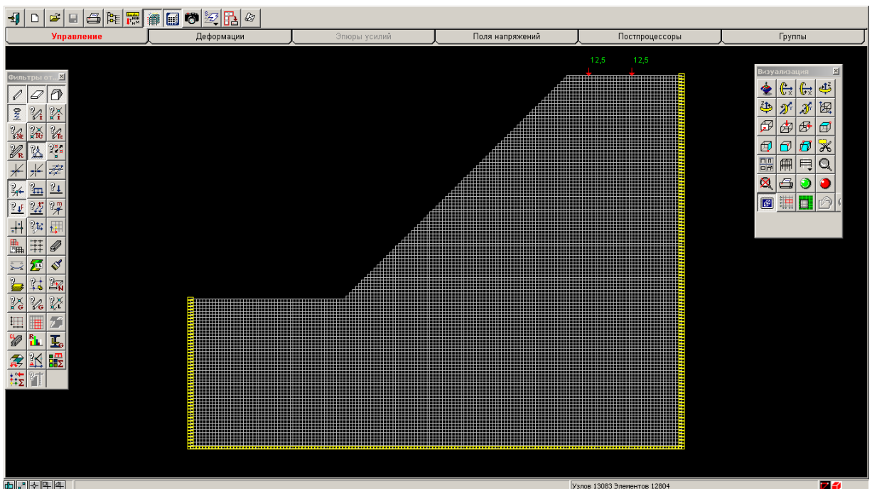
Рисунок 2 – Розрахункова схема, у програмному комплексі SCAD, навантаження НК-100 у формі зосереджених сил
