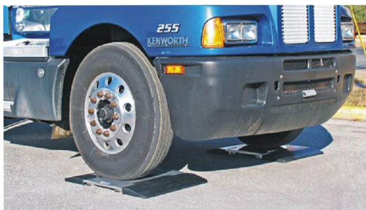
Рисунок 3 – Загальний вигляд зважування пересувними мобільними комплексами (MEDIUM speed) [7]
