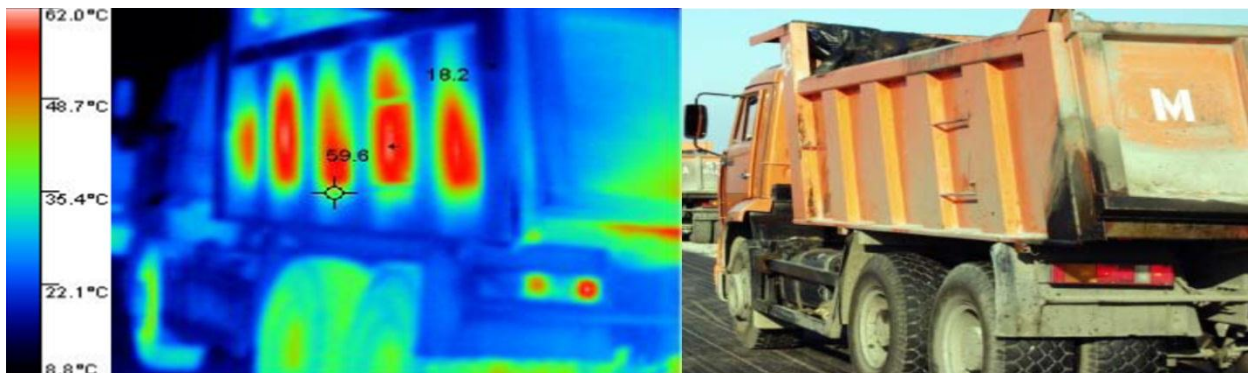
Рисунок 3 – Нерівномірність остигання суміші в кузові автомобіля
