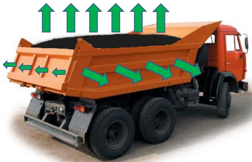
Рисунок 2 – Втрати тепла із кузова автосамоскида в навколишнє середовище
