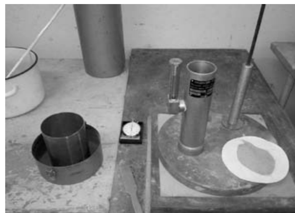
Рисунок 2 – Прилад конструкції В.С. Сиралєва для фільтраційних випробувань ущільнених зразків піску
