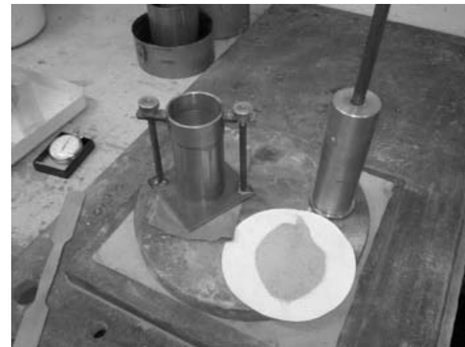
Рисунок 1 – Пристрій для ущільнення піску у фільтраційному циліндрі приладу КФ-00М
