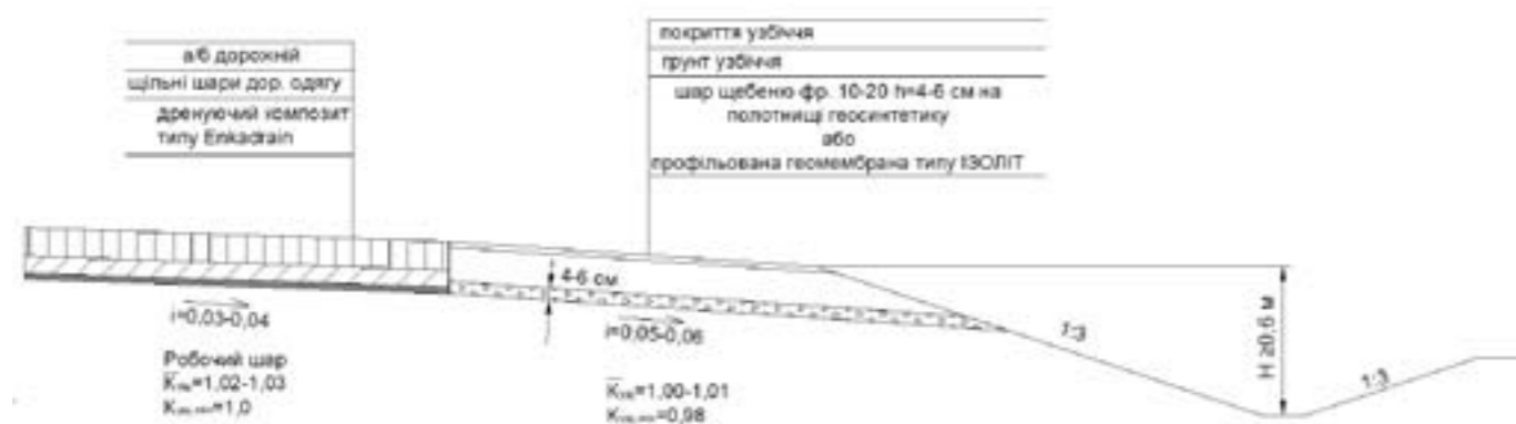
Рисунок 4 – принципова схема дренажу основи дорожніх одягів і узбічч за новою концепцією
