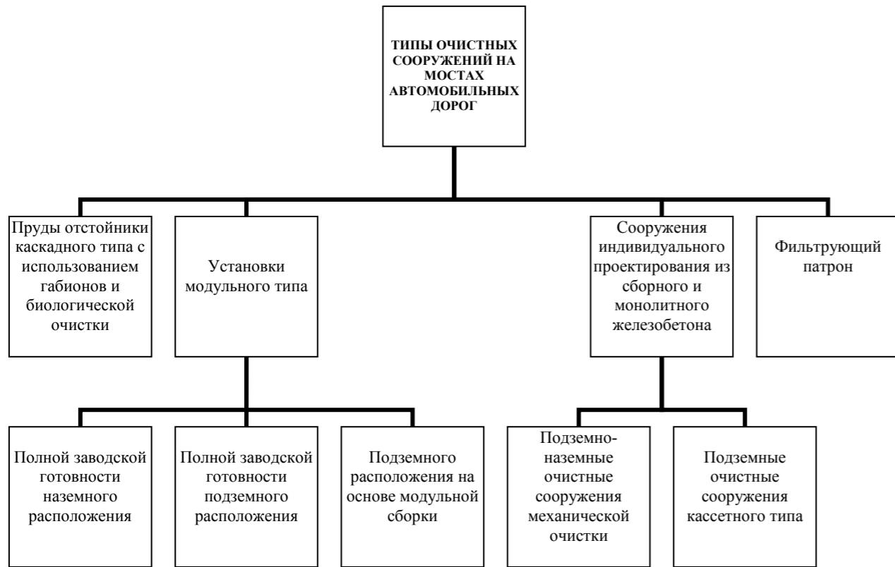
Рисунок 1 - Сооружения, используемые при очистке ливневых стоков на мостовых переходах [7]
