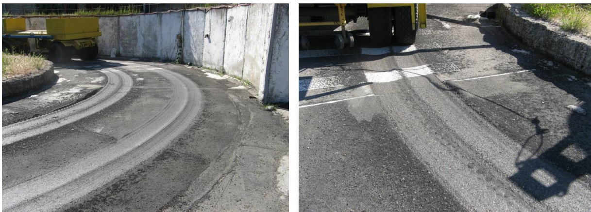
Рисунок 10 – Вигляд покриття з асфальтобетону армованого мікрОВОЛОКНАМИ КС- 12 після 6400 обертів стенду
