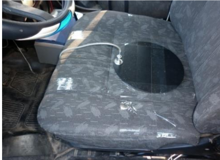
Рисунок 2 – Розташування віброакселерометру на місці сидіння водія автомобіля ГАЗ 2705
