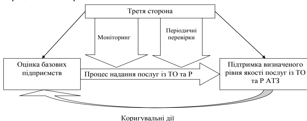
Рисунок 1 – Схема процесу моніторингу та коригування якості послуг із ТО та Р АТЗ
